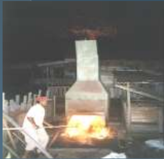
Tungku untuk membuat arang dari serbuk gergaji
