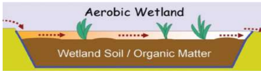
Gambar 1. Contoh pengelolaan AAT dengan sistem CW aerobik (Sumber : Zipper, et al. , 2011)
