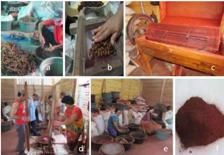
Gambar 3. Kegiatan pengolahan pasca panen buah rotan jernang, pemetikan buah (a); penggosokan buah (b); mesin penggiling (c); penumbukkan buah kering (d); penyaringan serbuk (e) dan resin jernang (f) (Foto: Lita, 2015)
